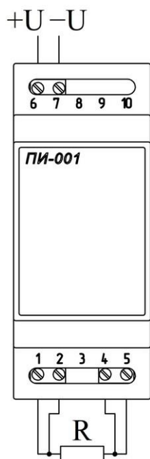
Рисунок 17в – преобразователь в корпусе Д, выходной сигнал 4-20 мА - HART
